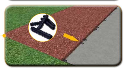
Installare la seconda fila sfalsandola rispetto alla prima di mezza piastra. Proseguire sfalsando le altre file a completamento della superficie
