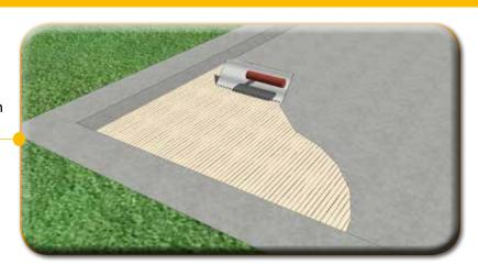
Installare la prima fila di mattonelle "Interlocking cut V" fino al bordo dall'altro lato controllando il corretto allineamento e la perpendicolarità
