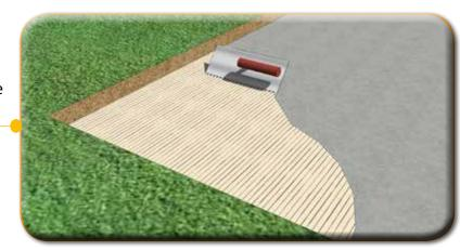
Installare la prima fila di piastre fino al bordo dall'altro lato controllando il corretto allineamento e la perpendicolarità
