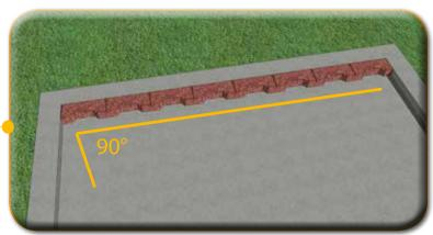
Iniziare la seconda fila con una mattonella del tipo "Interlocking Cut O"
