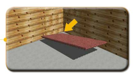
Installare la prima fila di piastre fino al bordo dall'altro lato controllando il corretto allineamento e la perpendicolarità
