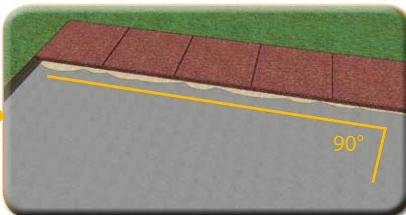
Proseguire la posa delle altre file di piastre a completamento della superficie
