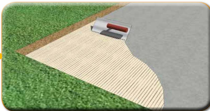
Installare la prima fila di piastre fino al bordo dall'altro lato controllando il corretto allineamento e la perpendicolarità
